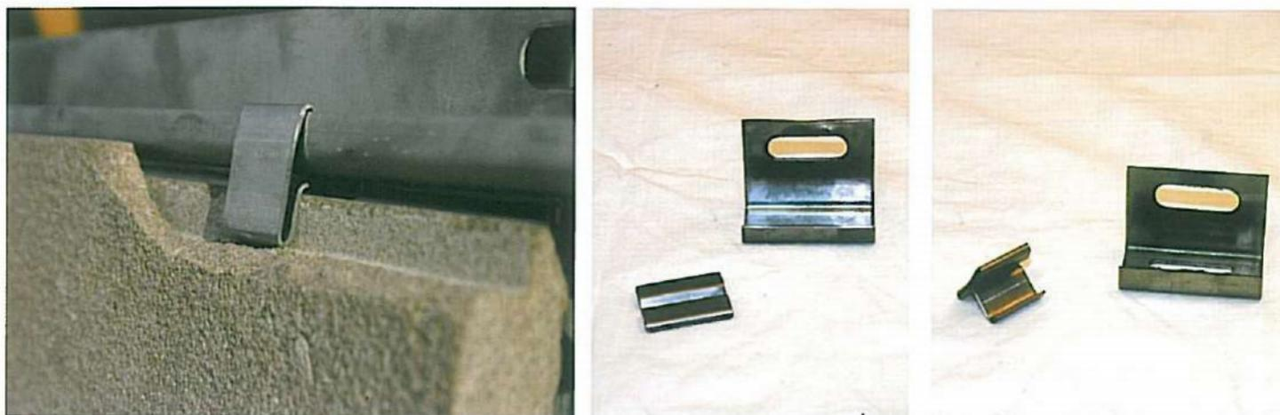
Il nuovo sistema di ancoraggio qui presentato è adatto alla realizzazione di facciate ventilate, con caratteristiche innovative in termini di modularità, flessibilità, così come di facilità di montaggio e affidabilità in opera. Con questo sistema si possono utilizzare materiali lapidei dello spessore minimo di 2 cm, con il solo limite della altezza delle lastre di non più di 40 (o 50) cm; questa limitazione però può essere aggirata salendo opportunamente con gli spessori...
